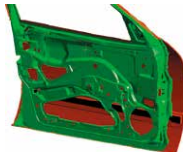
HOLOS-NT还可在1个软件上对车门整体那样难度大的测量对象进行测量。HOLOS Geo可对标准几何元素进行测量，而HOLOS Light和Extended可对复杂的自由曲面进行测量，覆盖所有的测量对象。
